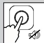
Stummschalt-Taste zur Unterdrückung des Alarmsignals
